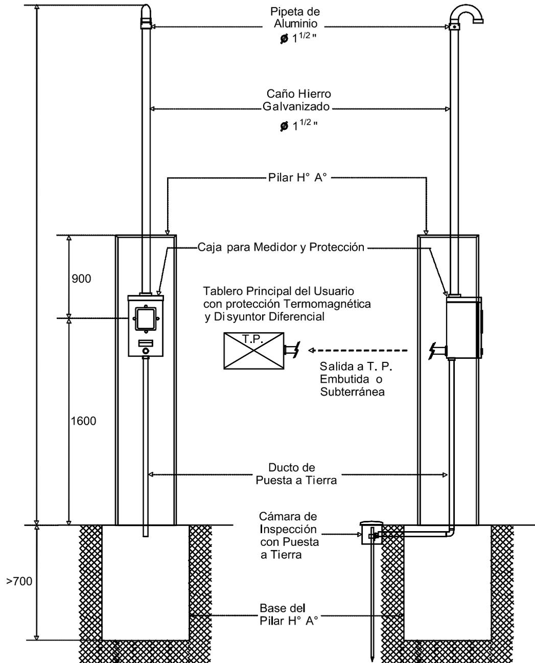
MANUAL PARA CONSTRUCCIÓN DE PUESTOS DE MEDICIÓN
