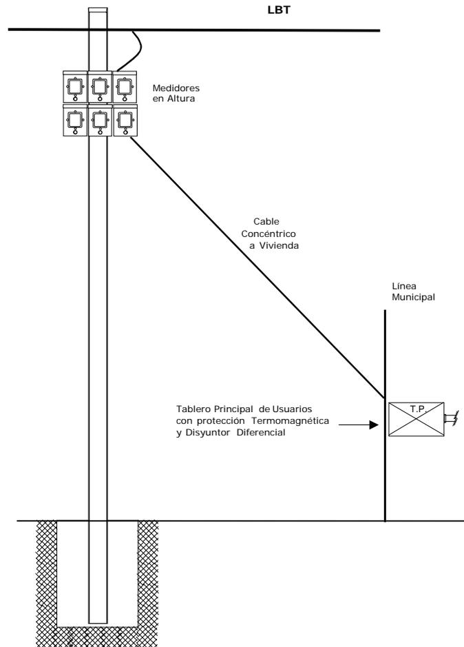
MANUAL PARA CONSTRUCCIÓN DE PUESTOS DE MEDICIÓN
